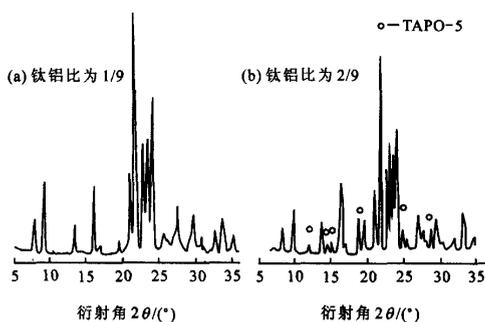
图3 以二异丙胺和二正丙胺为模板剂合成的 TAPO-11 随钛铝比变化的 XRD 谱图
