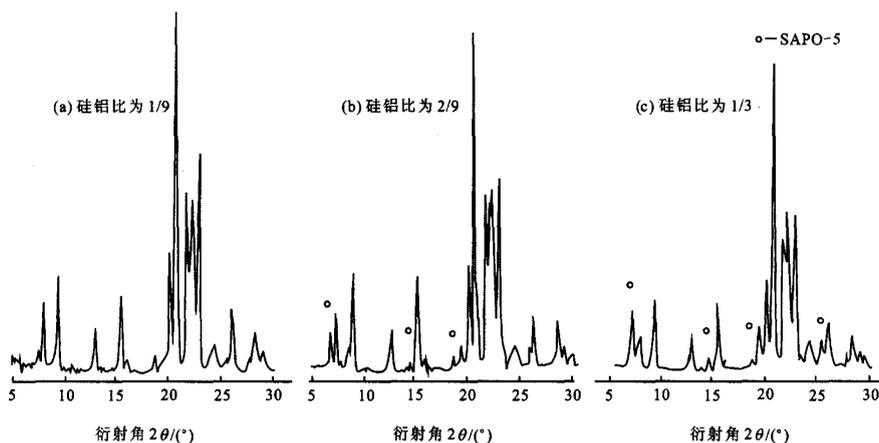
图2 以二异丙胺和二正丙胺为模板剂合成的 SAPO-11 随硅铝比变化的 XRD 谱图
