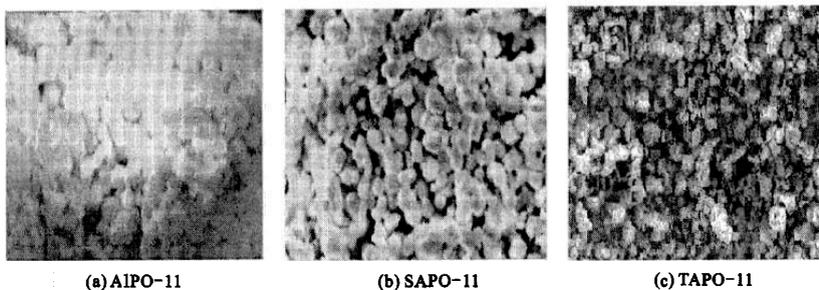
图6 AEL 骨架结构分子筛的扫描电镜照片
