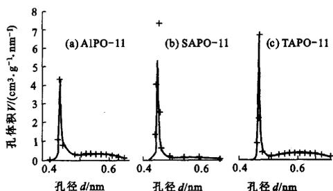
图 7 AEL 骨架结构分子筛微孔孔径分布图
