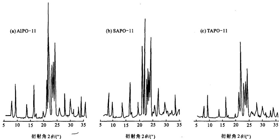
图 1 AEL 骨架结构分子筛的 XRD 谱图
