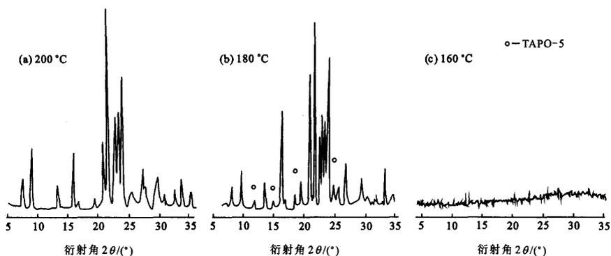
图5 TAPO-11 分子筛随温度变化 XRD 谱图
