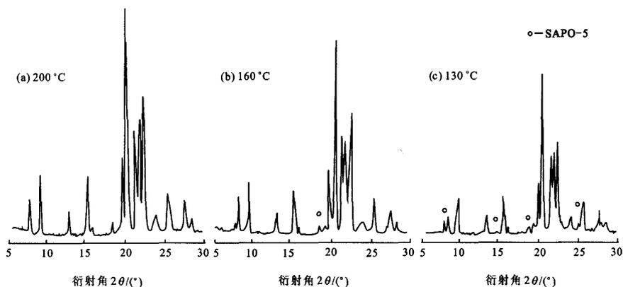
图4 SAPO-11 分子筛随温度变化的 XRD 谱图
