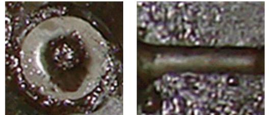
图2 磨损后的喷嘴实物图
