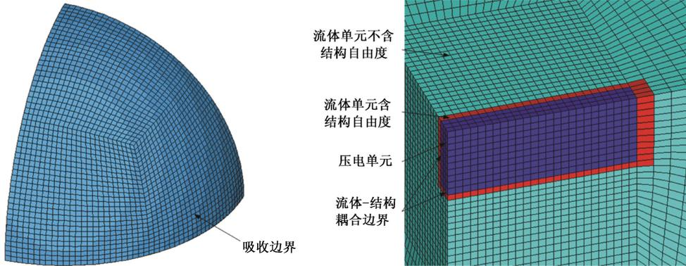
图2 接收器的八分之一流体有限元模型
