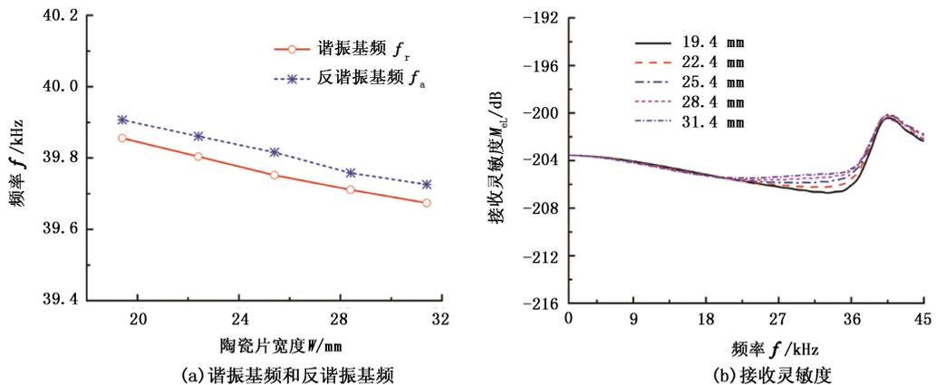
图4 接收器的性能指标随宽度变化曲线
