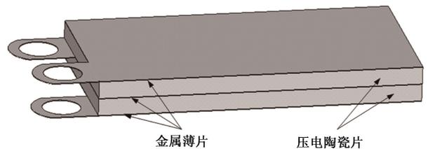
图8 并联型接收器的三维结构图
