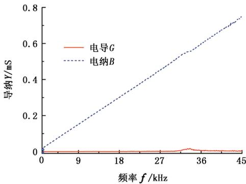
图 9 接收器硅油中实测的导纳特性曲线
