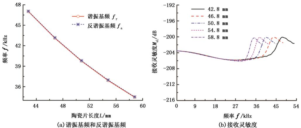
图3 接收器的性能指标随长度变化曲线
