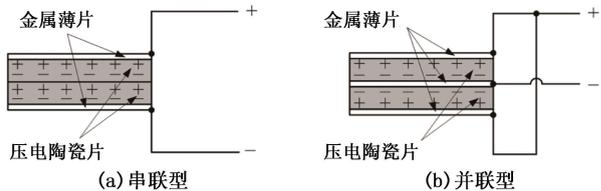
图 1 串、并联型接收器的结构示意图
