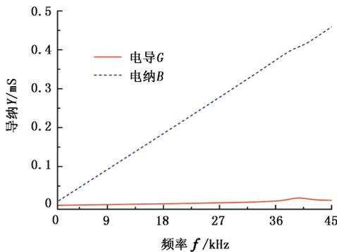
图6 接收器流体中的导纳特性曲线
